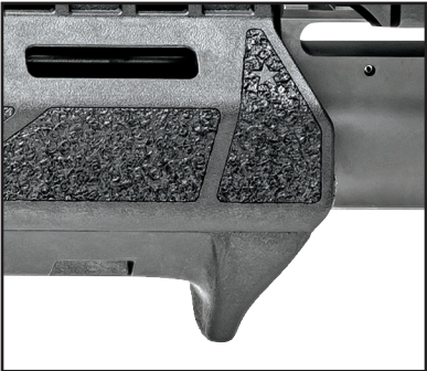
TOPE LIMITADOR INTEGRADO AO GUARDA MÃO
